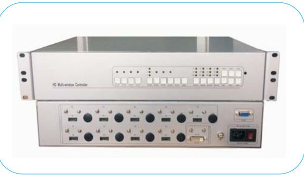
2U 机箱外壳/ 适用规格：5 画面|6 画面|8 画面|9 画面 机箱尺寸：484mm(长)*88mm(高)*300(深)mm
